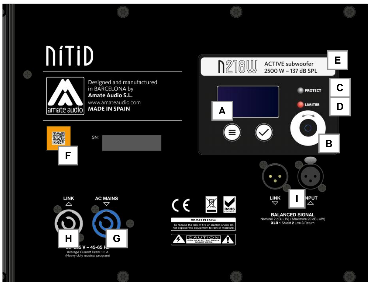
Fig. 17. Panel de control y conexiones del N18W, N218W
